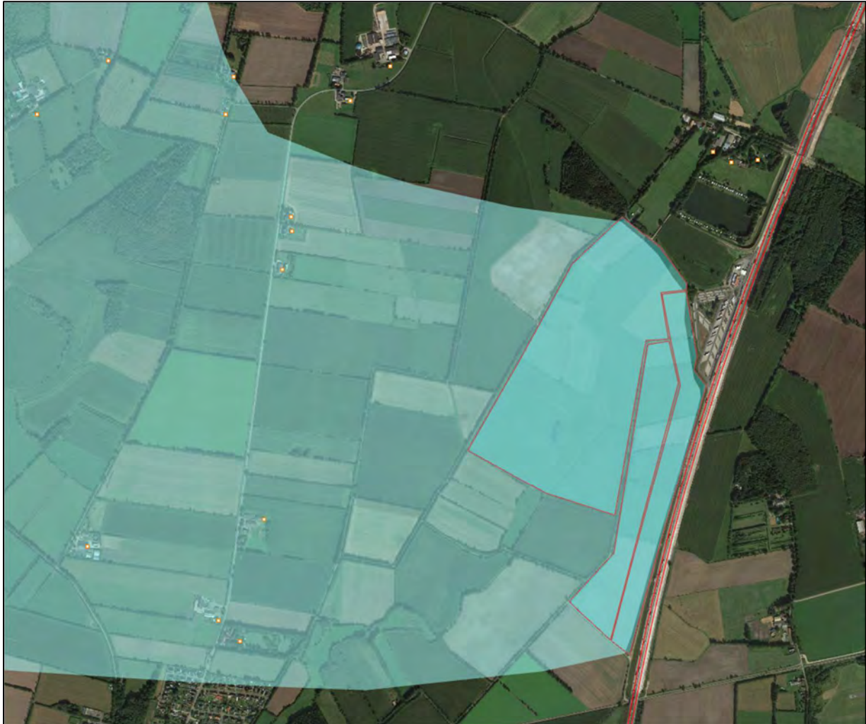
Abbildung 2: Einstrahlungsbereich BAB 7, PV-Paneele 20°Neigung
